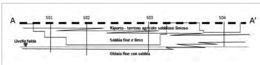
Figura 2.3 Profilo litologico di scavo
